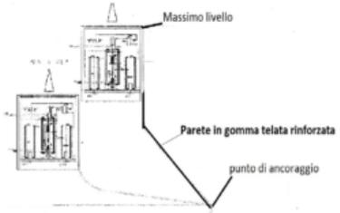
Barriera mobile idroelettromagnetica compressa per la difesa dalle acque alte con spinta di Newton e Lorentz
